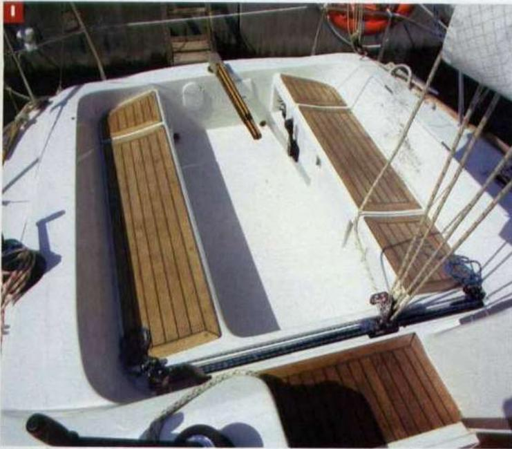
**1.** La timoneria a barra e il trasto in posizione avanzata consentono di sfruttare in modo completo le ottime dimensioni del pozzetto.
